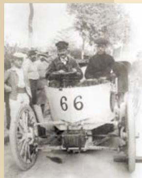
Dalla Parigi-Amsterdam-Parigi (v.pag.165) l'aerodinamica dell'**Amédée Bollée Fils** si era evoluta e faceva pensare alla prua di una nave. Quella di Giraud, chiamata 'torpediniera', aveva un motore di 6,3/20cv.
