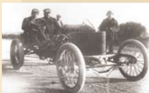
Nel 1905, una Darracq , vicino alla città Romana di Arles in Provenza, stabilì un nuovo record di velocità a 176 Km/h. Primo esempio di motore 8V costruito unendo due blocchi da 4 cilindri ciascuno.
